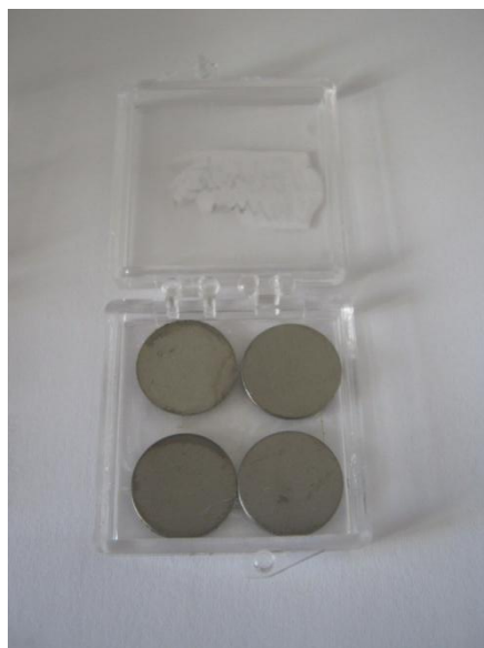
Figura 5. Discuri metalice de titan pe care a fost depus un microfilm de HA-AL 20 mM prin MAPLE
